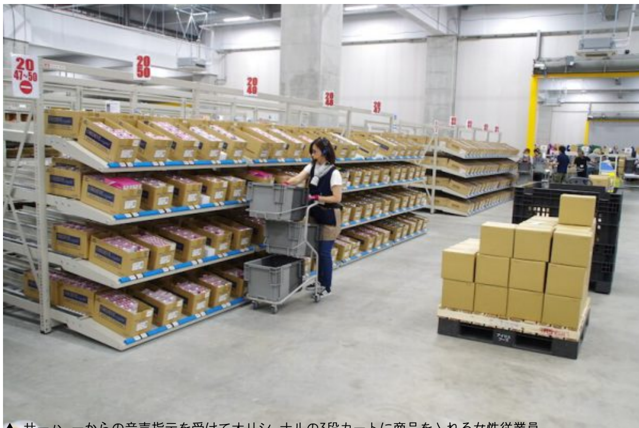
▲ サーハ、ーからの音声指示を受けてオリジナルの3段カートに商品を入れる女性従業員
