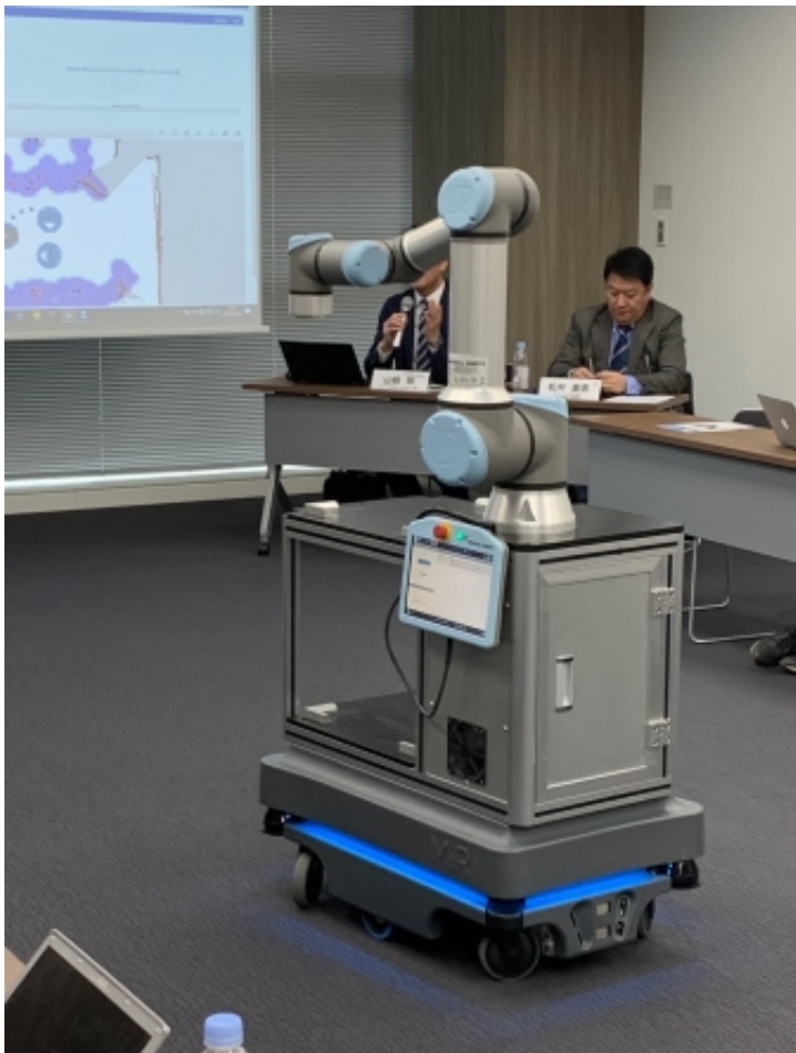
▲Mobile Industrial Robots社の自律走行型搬送ロボットに搭載したデモンストレーションの様子
