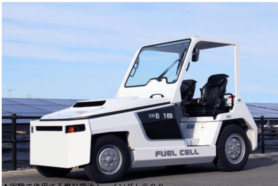
▲実験で使用する燃料電池トローリングトラクター
