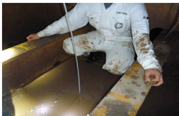
図 4. 2 変形の計測方法（商船三井提供）
