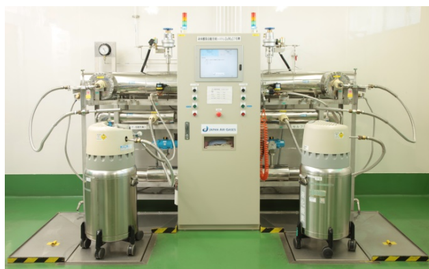
カネコ商会の取り扱っている医療用ガス充填設備
