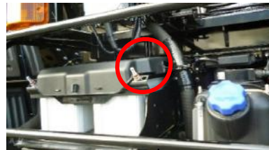
不具合対象部位(バッテリー)
